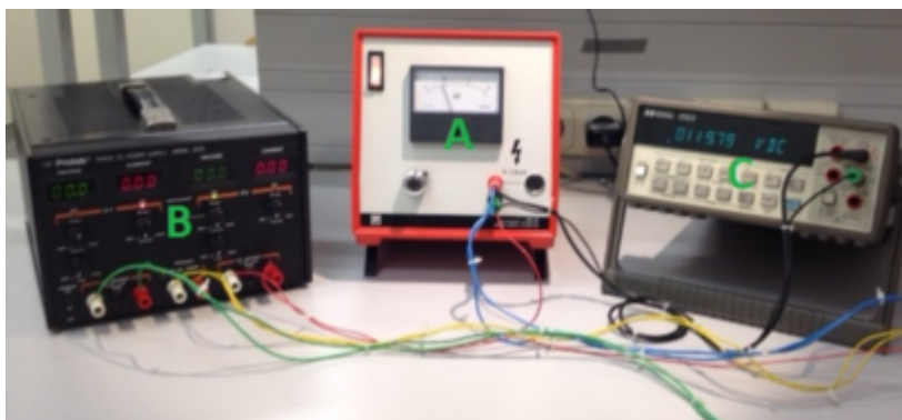
2. ábra. A mérési elrendezés, balról jobbra: kis feszültségű DC tápegység, nagy feszültségű tápegység, digitális multiméter.
